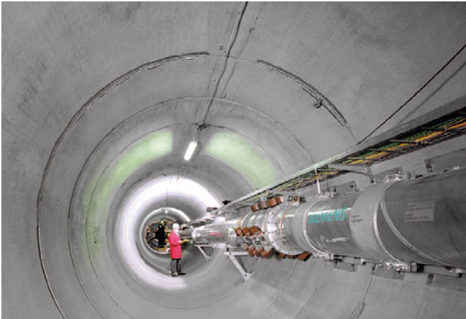
Figura 2.5-3: Configuración de prueba a largo plazo en IPH, Berlín
